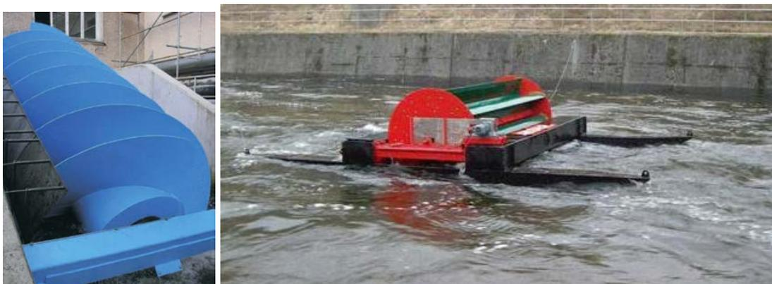
**Abb. 32: Wasserkraftschnecke und Schwimmwasserrad im Einsatz [DUH 2013]**
