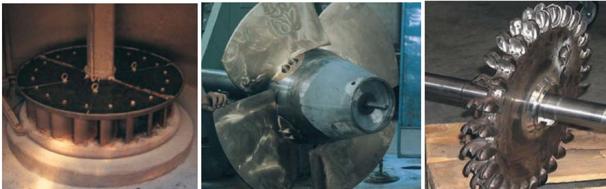
**Abb. 31: Laufräder verschiedener Wasserkraftturbinen v.l.n.r. Francis-, Kaplan- und Pelton-Laufrad [Energieroute 2013]**
