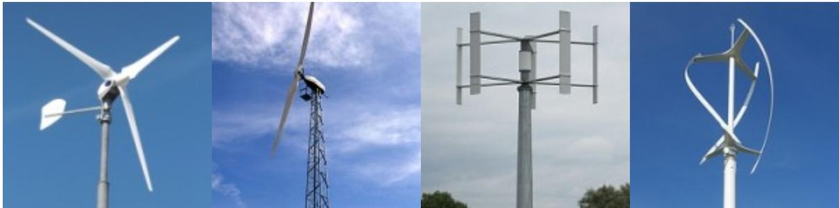
**Abb. 36: Beispiele für Horizontal- und Vertikalachsenanlagen [BWE 2013]**
