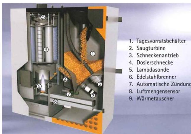
**Abb. 26: Schnittdarstellungen eines Pelletkessels [Solarfocus 2013]**
